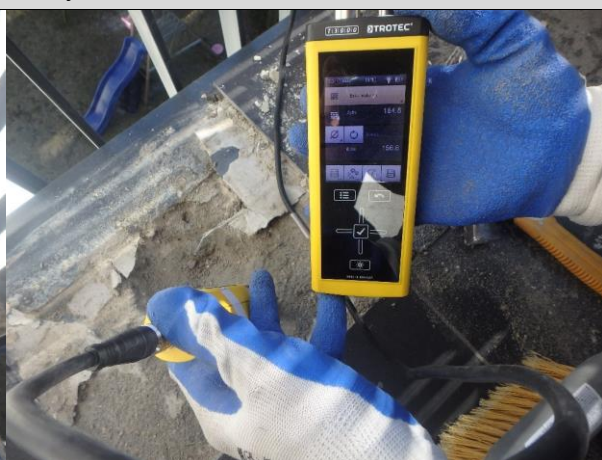
Fot. 03_12. Zmierzona wilgotność szlichty 185[digits] – przegroda mokra.
