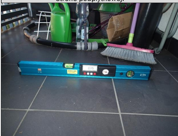
Fot. 16 . Zmierzona wartość spadku od 0,35% do 2,44%, tj. miejscowo poniżej wartości projektowanej w wymiarze 1%.
