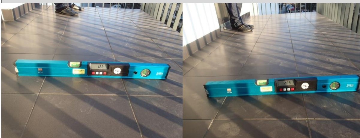
Fot. 43, 42. Zmierzona wartość spadku od 1,22% do 2,09%, - zgodnie z projektem [1].
