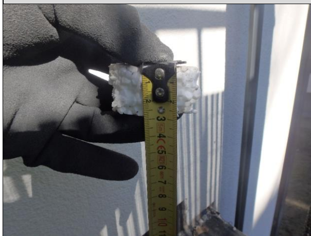
Fot. 03_18. Grubość styropianu 3cm.
