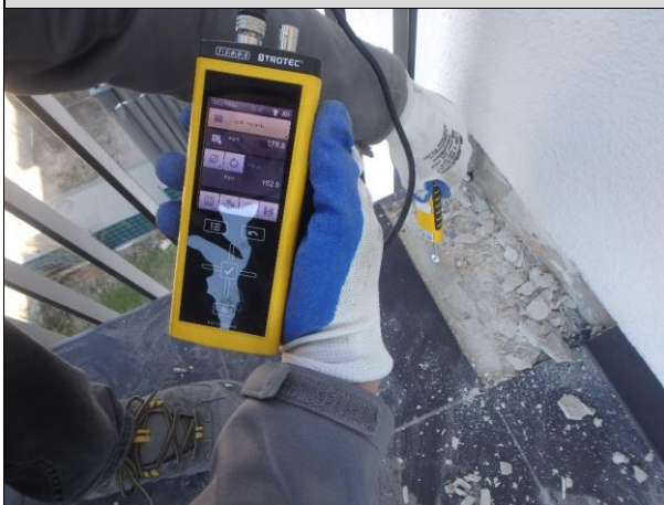
Fot. 02_7. zmierzona wilgotność kleju 176 [digits] – przegroda mokra.
