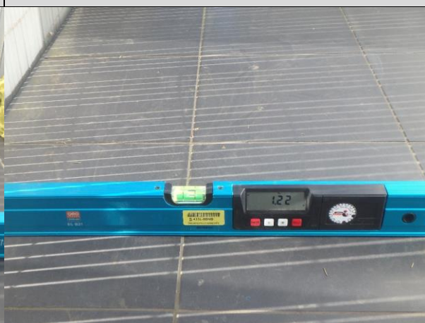
Fot. 20, 22. Zmierzona wartość spadku od 0,87% do 1,22%, tj. miejscowo poniżej wartości projektowanej w wymiarze 1%.
