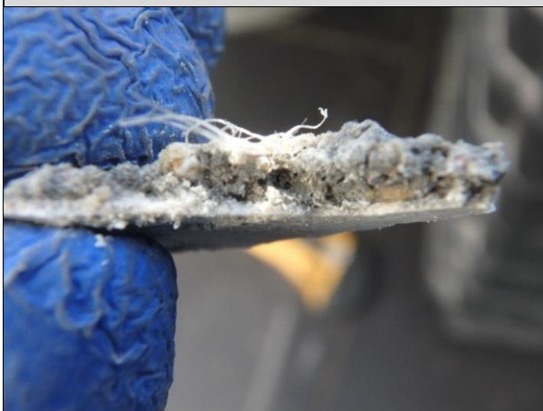
Fot. 03_10, 03_11. Zmierzona grubość izolacji podpłytkowej w miejscu odkrywki ok 0,9mm . Izolacja „pocieniona” – powinno być min 2,0mm .
