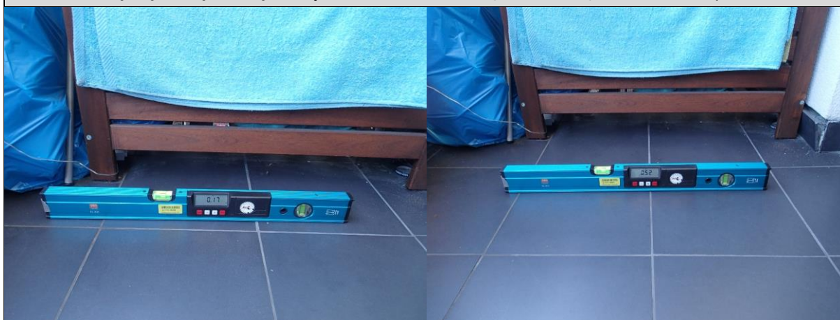
Fot. 15 , 12. Zmierzona wartość spadku od 0,17% do 0,52%, tj. poniżej wartości projektowanej w wymiarze 1%.
