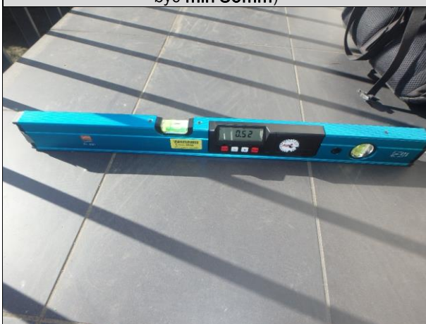
Fot. 15, 14. Zmierzona wartość spadku od 0,52% do 0,70% , tj. poniżej wartości projektowanej w wymiarze 1% .
