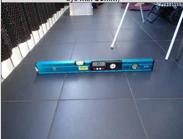
Fot. 20, 22 . Zmierzona wartość spadku od 0,87% do 1,75% , tj. miejscowo poniżej wartości projektowanej w wymiarze 1%.
