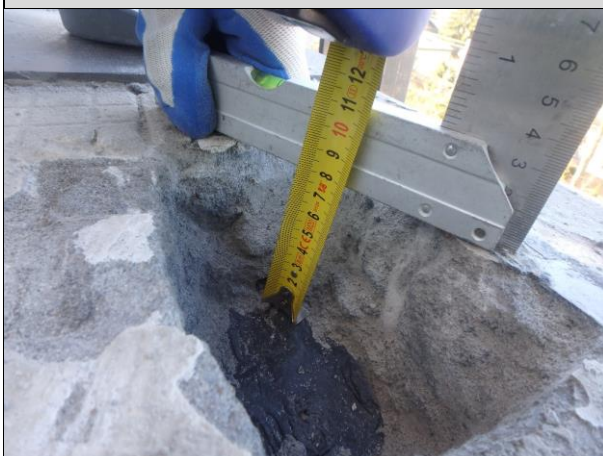
Fot. 01_21. Zmierzona grubość szlichty (fot. 01_21).
