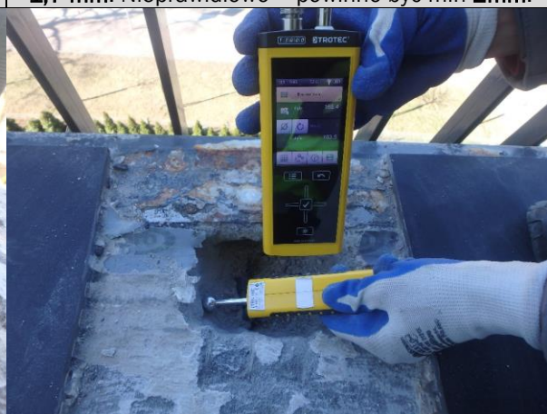
Fot. 01_20. Zmierzona wilgotność szlichty 165[digits] – przegroda mokra.
