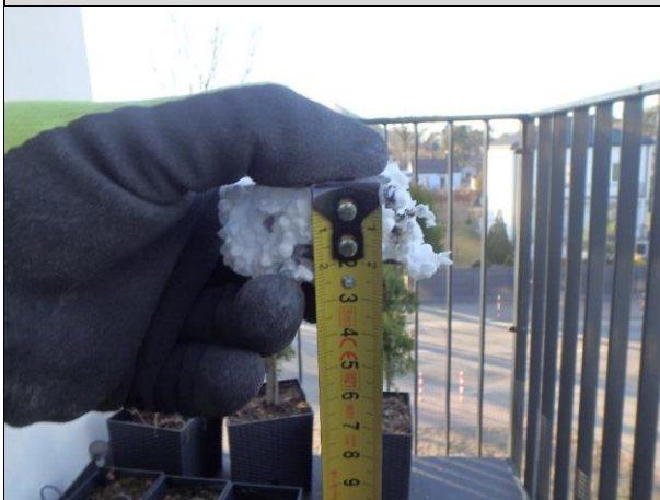
Fot. 04_14. Grubość styropianu 2cm.
