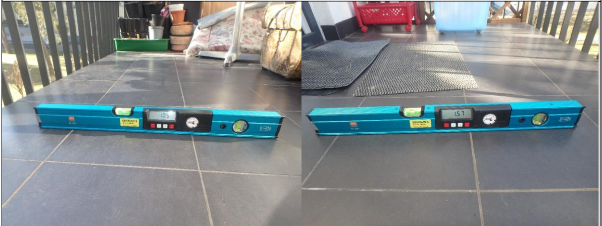
Fot. 25, 24. Zmierzona wartość spadku od 1,05% do 1,57%, tj. zgodnie z projektem [1]
