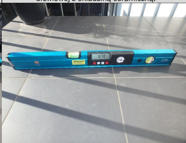
Fot. 15, 14. Zmierzona wartość spadku od 0,52% do 0,70% , tj. poniżej wartości projektowanej w wymiarze 1% .
