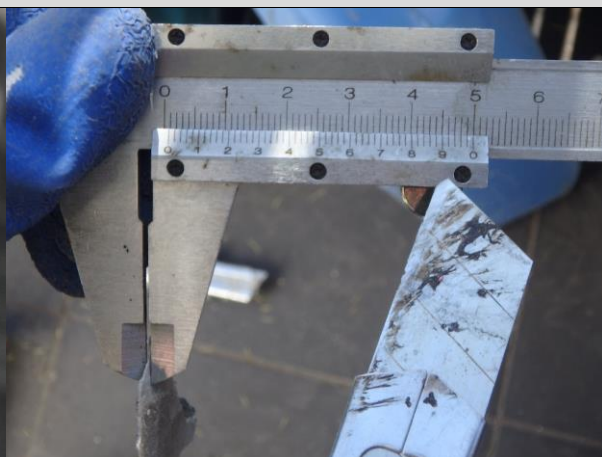
Fot. 03_10, 03_11. Zmierzona grubość izolacji podpłytkowej w miejscu odkrywki ok 0,9mm . Izolacja „pocieniona” – powinno być min 2,0mm .
