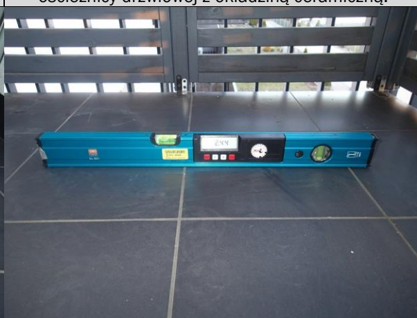
Fot. 16 . Zmierzona wartość spadku od 0,35% do 2,44%, tj. miejscowo poniżej wartości projektowanej w wymiarze 1%.
