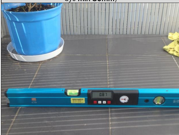
Fot. 20, 22. Zmierzona wartość spadku od 0,87% do 1,22%, tj. miejscowo poniżej wartości projektowanej w wymiarze 1%.
