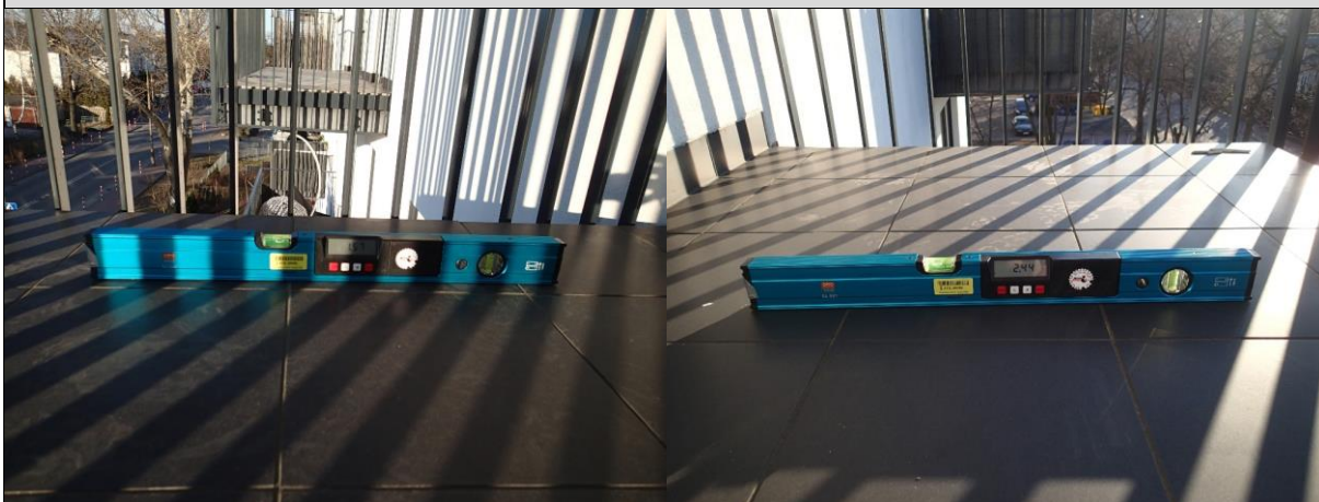
Fot. 12, 13. Zmierzona wartość spadku od 1,57% do 2,44%, - zgodnie z projektem [1]
