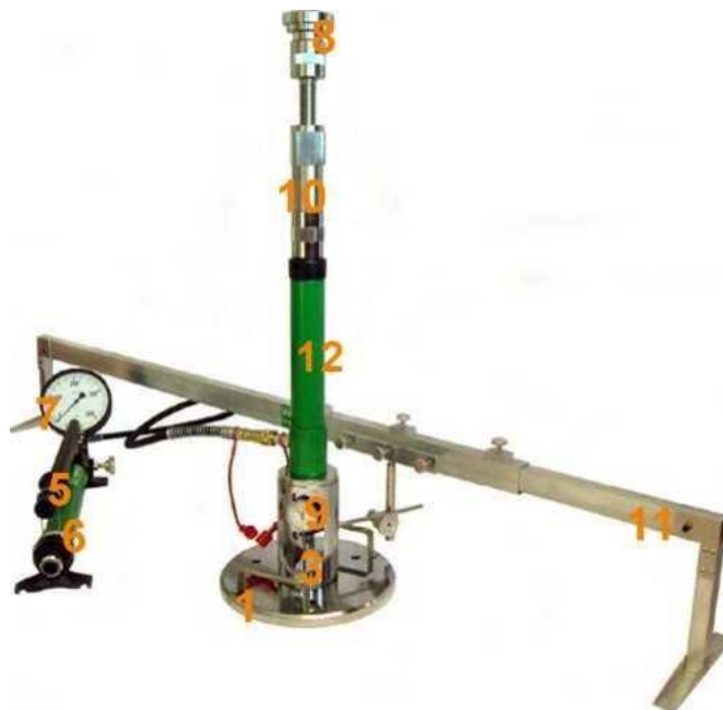
Rys. 1.2 Aparatura VSS z jednopunktowym pomiarem przemieszczenia płyty
