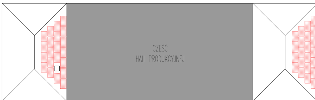
Rysunek 41. Układ paneli na części socjalno-biurowej i magazynowej budynku B4
