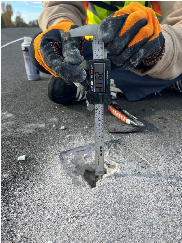
Rysunek 33. Pomiary grubości warstw gładzi cementowej i styropianu
