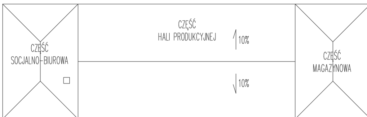
Rysunek 2. Układ połaci dachu na budynku B4
