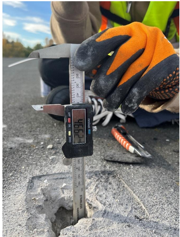
Rysunek 33. Pomiary grubości warstw gładzi cementowej i styropianu
