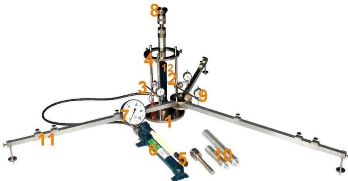
Rys. 1.1. Aparatura VSS z trzypunktowym pomiarem przemieszczenia płyty
